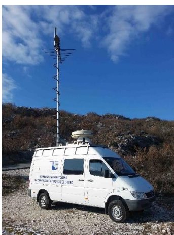
Mobilna kontrolno-mjerna stanica (MKMS) u vozilu Mercedes-Benz® Sprinter
